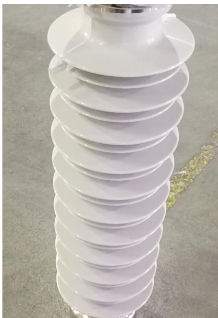
Zdj. 1. Izolator po wyjęciu z formy
