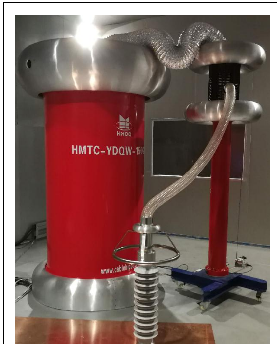
Zdj. 11. Stanowisko do badania wyładowań niezupełnych
