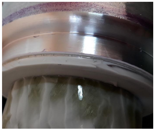
Zdj. 9. Widok powierzchni granicznych po ścięciu osłony
