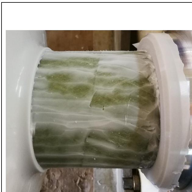
Zdj. 3. Wygląd okucia po ścięciu osłony silikonowej
