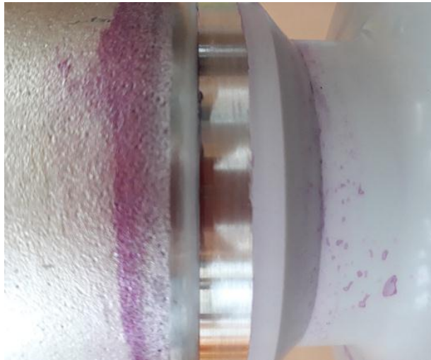
Zdj. 8. Widok osłony po zmyciu środka penetrującego
