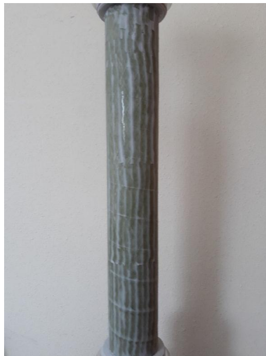
Zdj. 4. Wygląd powierzchni rury i okuć po ścięciu osłony silikonowej
